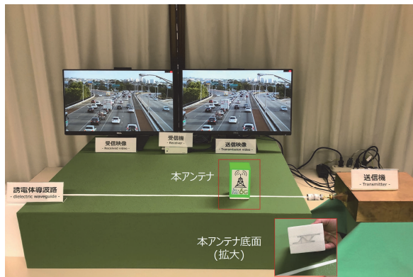
写真6 「置くだけアンテナ」によるカバレージ拡張デモ
