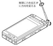
●ワンセグアンテナを収納するには、ワンセグアンテナの下の方を持って止まるまで押し入れます。
