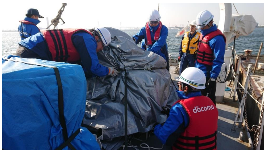
【積み込み機材固定】 輸送機材の固定、航走時に荷崩れしないよう安定性を確認
