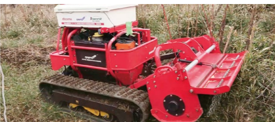
通信システムを活用した下刈り作業機械の遠隔操作の様子
