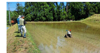
「棚田」での画像認識AIを活用した水田除草ロボット
