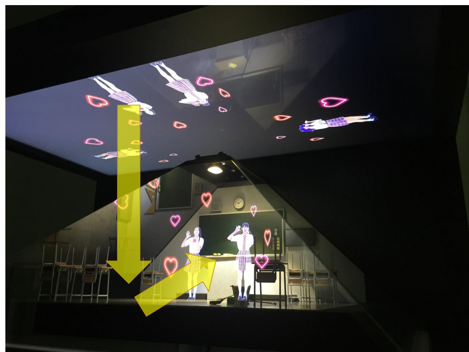
上部のディスプレイの映像を 透明のスクリーンに反射させると 内側に浮き出て見える
