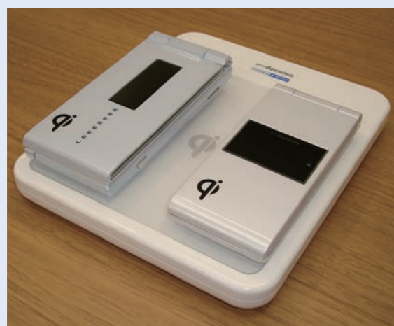
写真1 WPC方式ワイヤレス充電ケータイ/充電置き台
