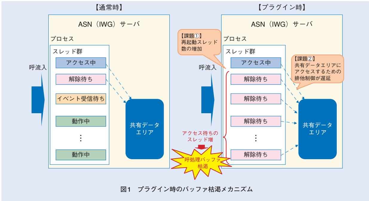
呼制御処理プロセスからの要求イベント取得とSMS-BOXへの書き込み処理を行うが、前者に比べて後者の処理は低速であるため、後者の処理を行うイベントはバッファリングされ、一定量蓄積されたことを機に一括して書き込み処理を行っている。このバッファリングされるデータ量（以下、書き込みサイズ）を変更する検討を行った。
